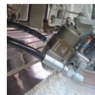
La sezione fluidi offre un facile accesso alle tenute del pistone di pompaggio della vernice.
